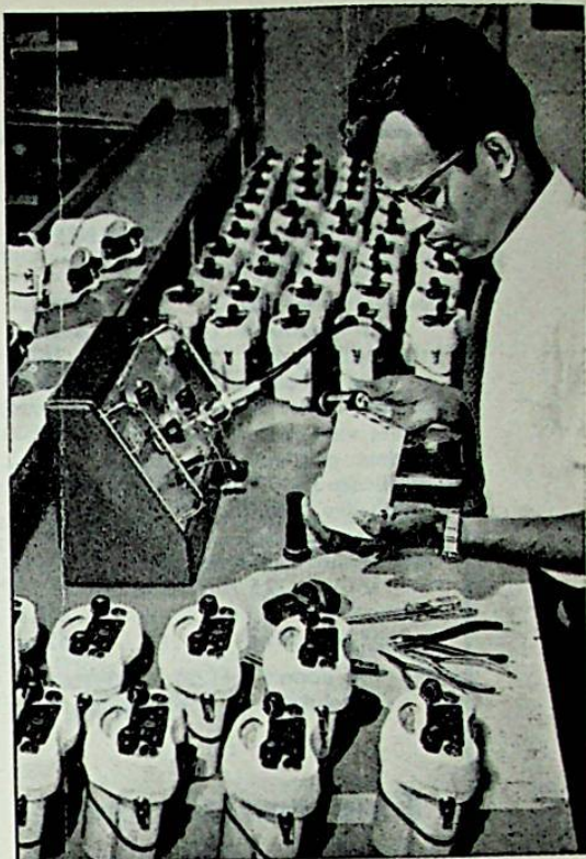
NA FABRICATIE VAN DE AVO RADIAC SURVEY METER MK 6 vindt controle, ijking en beproeving plaats in de fabriek te Westminster.
